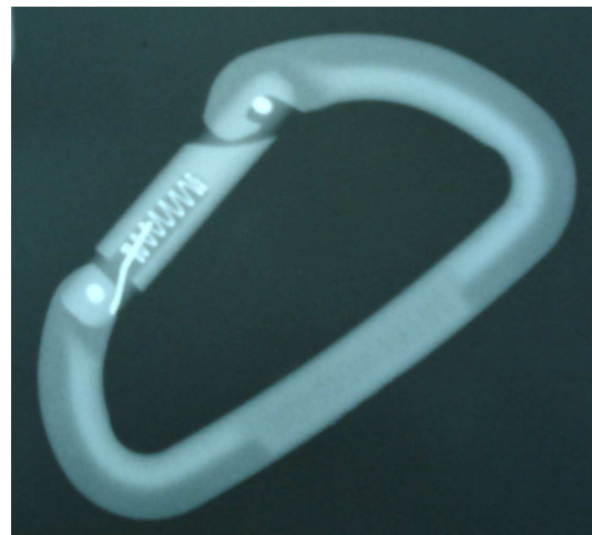
Figura 1: Radiografía de un mosquetón de escalador fabricado en una aleación de aluminio.
