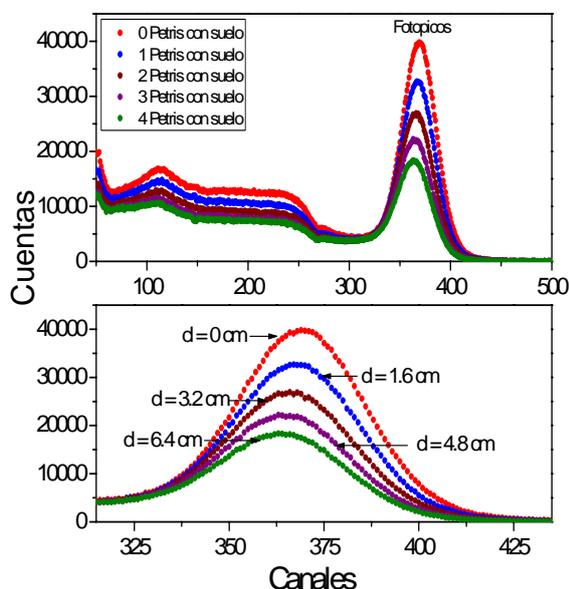
Figura 1. a) Espectros de la fuente de  $^{137}\text{Cs}$  interponiendo distintos espesores de absorbente y b) Vista ampliada en la zona de los fotopicos. La letra  $d$  indica el espesor de suelo usado para la medida.
