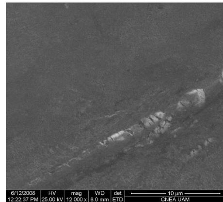
Figura 5: Imagen tomada con un microscopio SEM de la muestra no irradiada. Se observan las vetas propias del laminado del material.
