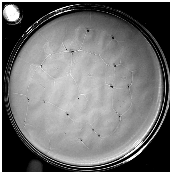
Figura 7. Registro fotográfico del diagrama de celdas de Bénard en el laboratorio con flujo completamente desarrollado.
