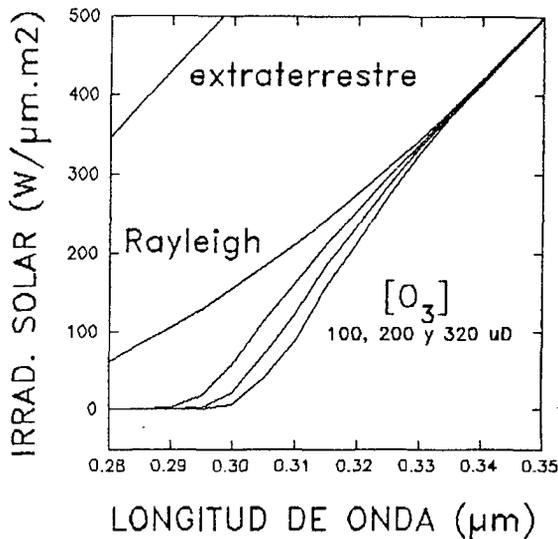
Fig.3: Variación de la irradiación solar en la superficie terrestre en función de la cantidad de ozono. Se ha indicado el espectro fuera de la atmósfera y el efecto del scattering molecular.
