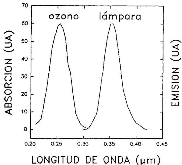
Fig. 2: Espectros de absorción del ozono y de emisión de las lámparas UV utilizadas en tratamientos de Psoriasis que muestran las coincidencias con las zonas activas de los cristales utilizados en este trabajo.
