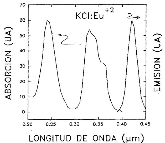
Fig. 1: Espectros de absorción y emisión del sistema  $KCl:Eu^{+2}$ . Un cristal de 1 mm de espesor con una concentración del 1% de Eu tiene una densidad óptica máxima de 3, de manera que absorbe prácticamente todo el UV que incide sobre él.
