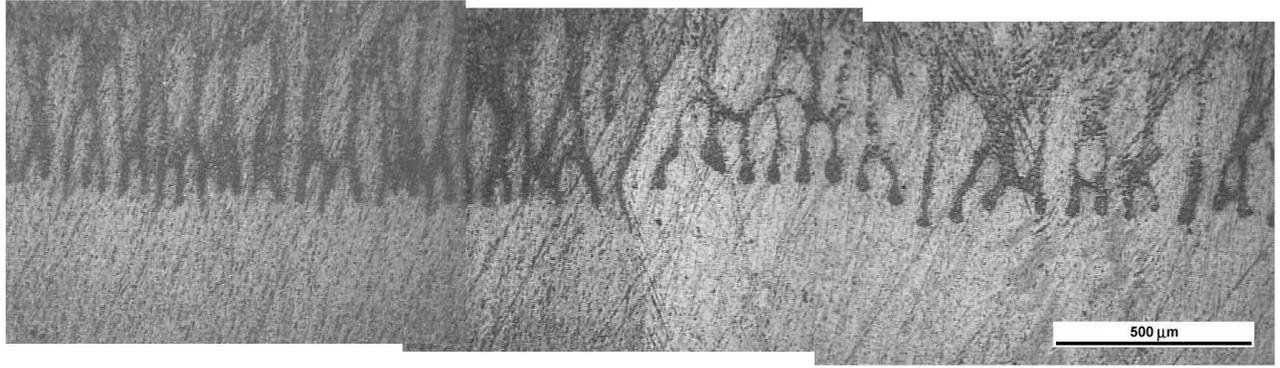
Figura 2: Frente plano acelerado. El ángulo entre la dirección de extracción de calor y la dirección de crecimiento, genera diferentes condiciones críticas en la muestra.
