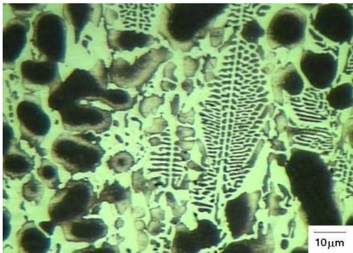
Figura 14: Micrografía óptica de la aleación Al-32%Ag-20%Cu.
