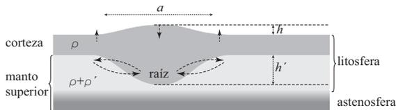
Figura 1: La corteza terrestre, la litosfera y la isostasia.
