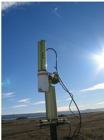
Figura 1. Fotómetro solar CIMEL instalado en el OAPA realizando una medición del espesor óptico de nubes.
