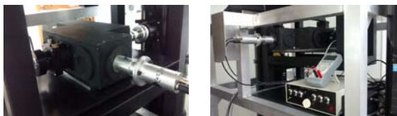
Figura 10: Vistas de la unidad de selección espectral junto a las unidades de detección instaladas.
