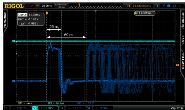
Figura 4: Pantalla de osciloscopio en modo permanencia de mediciones. Se observa el tiempo muerto entre mediciones. La escala temporal es de 20 ns/div. La escala vertical del canal de interés (azul, canal 4) es de 2 V/div. Se obtiene un pulso de salida de 25 ns con un tiempo mínimo entre eventos de 69 ns.
