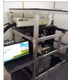
Figura 4. Sistema Lidar.
