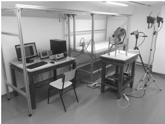
Figura 2: Panel izquierdo: Montaje completo con sistema PTV y tanque de ondas, construido en el Laboratorio de Turbulencia Geofísica (DF, FCEN, UBA) para el presente estudio. Panel derecho: Vista en detalle sobre la cuba de ondas, el sistema generador de oleaje y las cámaras que integran el sistema de PTV.
