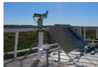
Figura 5: Fotómetro solar montado en el techo de la estación.
