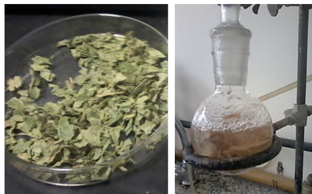
FIG. 2: Material vegetal triturado y procedimiento de obtención del cocimiento.
