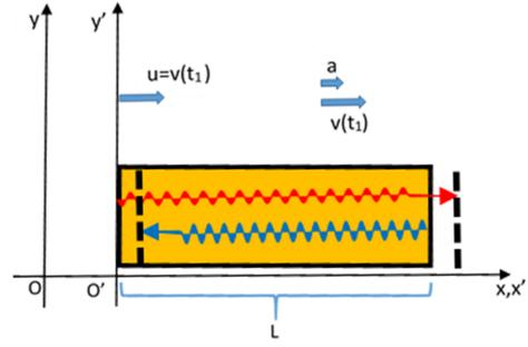
FIG. 2: Esquema de la ubicación de la cavidad en  $t_1$ . Las líneas segmentadas indican la posición de las paredes trasera y delantera de la cavidad al momento de ser alcanzadas por la radiación reflejada en  $t_1$
