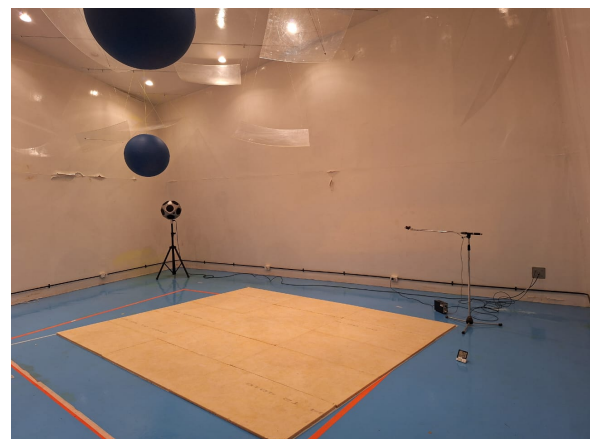
FIG. 4: cámara reverberante con paneles de Andina Rústico de la marca Isover.
