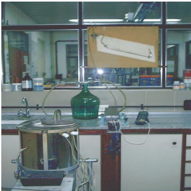
Figura 1: Equipo para ensayos de fluidez lineal de llenado por aplicación de vacío.
