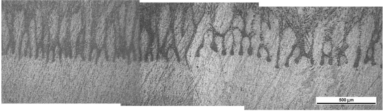
Figura 5: Imagen compuesta de un frente plano que se ha inestabilizado formando celdas. G_L = 25 \text{ K/cm} , V = 0,0075 \text{ cm/s} . El espaciado crítico de las celdas resultantes es diferente en ambos granos, por lo que \lambda_C es función de la orientación.
