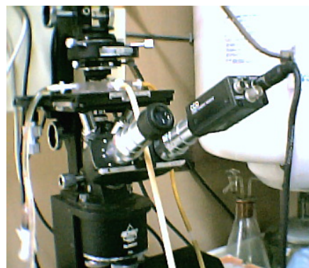
Figura 1: Imagen del microscopio invertido con la cámara CCD adaptada en un ocular.
