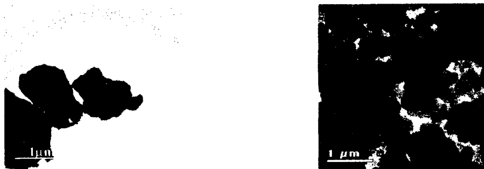
Figura 4: Micrografías MET de los polvos molidos. Izquierda, previo a la reacción; derecha luego de la reacción.
