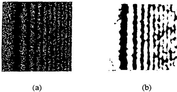
Figura 1. Franjas de correlación simuladas digitalmente, con tamaño de speckle de 2 pixels: (a) original; (b) filtrada con kernel de  $9 \times 9$  y 1 iteración.
