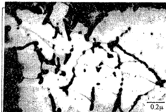
Figura 7. Baja densidad de dislocaciones en grano de ferrita en probeta ensayada hasta 2700 ciclos.
