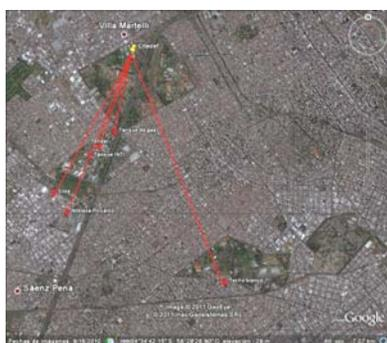
*Imagen satelital de la zona explorada con el telémetro láser. Distancia máxima alcanzada: 5,28 km*
