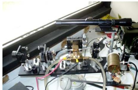
Detalle de la cavidad óptica junto con la óptica de colimación y la mira telescópica.
