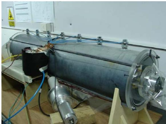
Figura 3. Vista general del láser con los siete alimentadores equiespaciados
